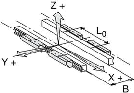
Eine Kassette mit einer Doppelschiene
