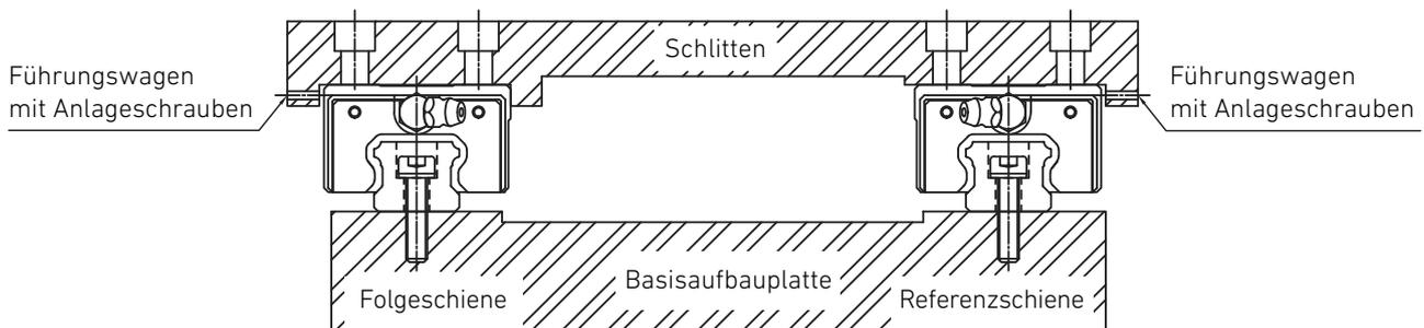
🔩 Anbringung der Profilschienenführung ohne Stellschrauben auf der Hauptführungsschiene
